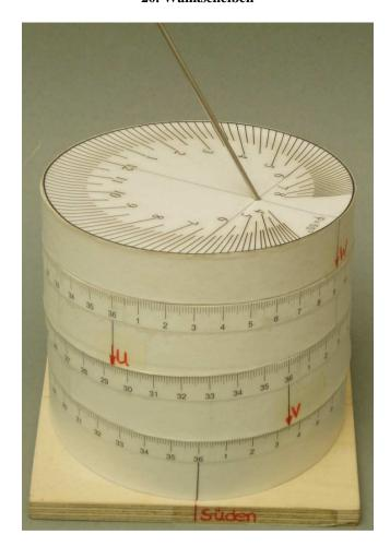
Mit Hilfe von Wankscheiben kann eine Sonnenuhr an die geographische Länge und Breite angepasst werden.
