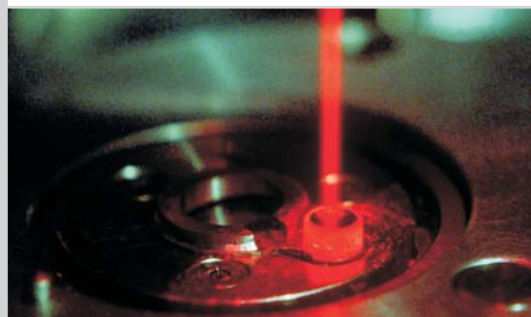
Ausrichtung des Hohlspiegels wird gemessen
