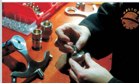
Montage des Kopfes, der die Justiermechanik enthält
