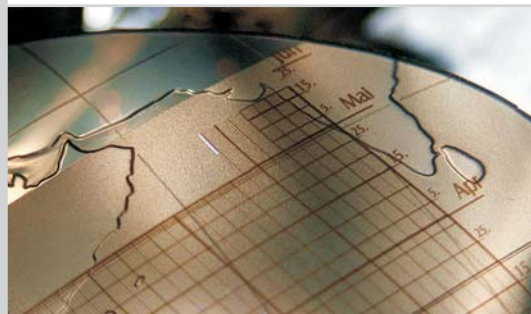
Laserlicht zeichnet die haarfeinen Linien der Sonnenuhrskala
