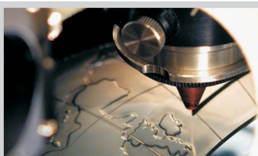
Globusschirm wird ausgeschnitten und gebohrt
