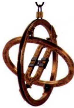
»UNIVERSALRINGSONNENUHR«: Ein Zeitmesser zum Zusammenklappen für die Westentasche nach einem Vorbild aus dem frühen 18. Jahrhundert. Zu beziehen über die Stiftung Huelsmann, Bielefeld: www.museumshuelsmann.de
