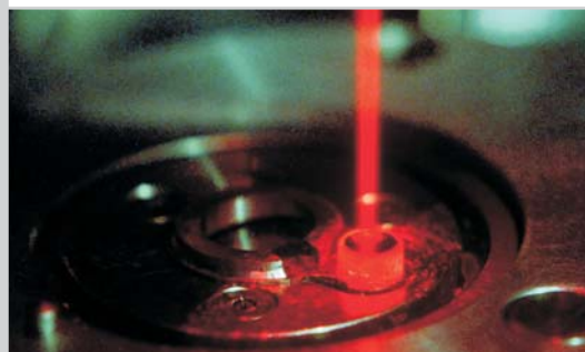
Ausrichtung des Hohlspiegels wird gemessen
