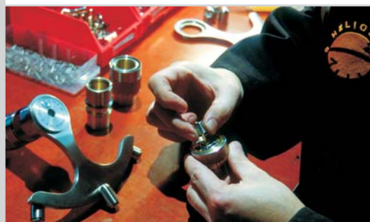
Montage des Kopfes, der die Justiermechanik enthält
