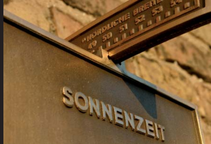
Das Zifferblatt ist für 50° nördliche Breite ausgerichtet.
