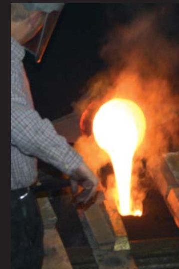
Die MERIDIANA entsteht im traditionsreichen Sandgussverfahren aus wertvoller Bronze. Handwerkliches Können und viel Erfahrung sind für das Gelingen erforderlich.
