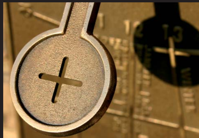
Der Kreuzgnomon projiziert das Sonnenlicht auf das Zifferblatt.
