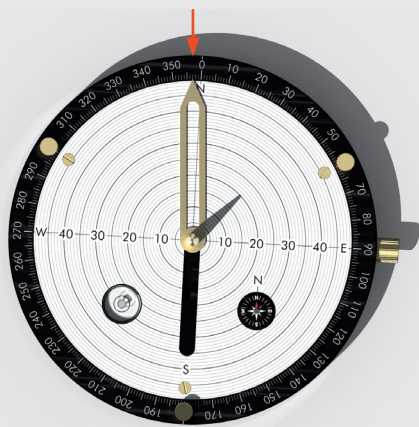
Bild 5c: Die Mitte liegt bei 357°. Dort markieren Sie die ermittelte Nordrichtung.
