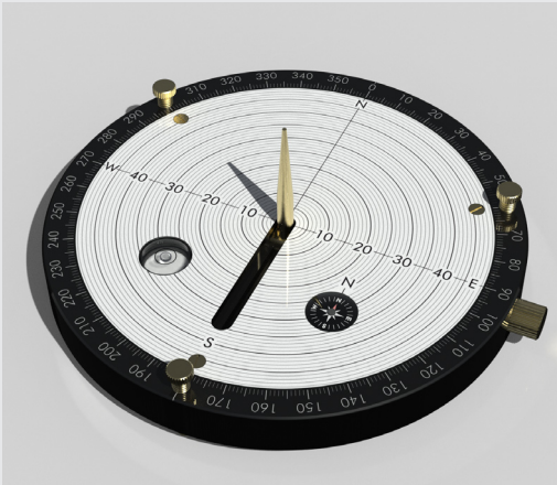
Bild 4a: Die Schattenlänge kann an der Kreisskala abgelesen werden und beträgt gerade 25 mm.
