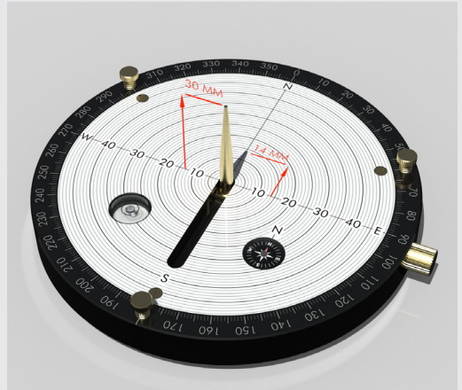
Bild 4b: Zum wahren Mittag erreicht die Sonne ihren Höchststand. Der Schatten ist am kürzesten und ist hier 14 mm lang. Der Gnomon ist 30 mm hoch.
