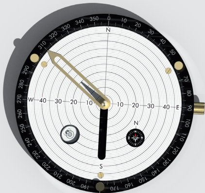
Bild 5a: Die Schattenlänge beträgt am Vormittag 20 mm bei 310°.
