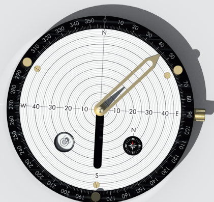
Bild 5b: Am Nachmittag erreicht der Schatten wieder den 20 mm Kreis bei 44°.
