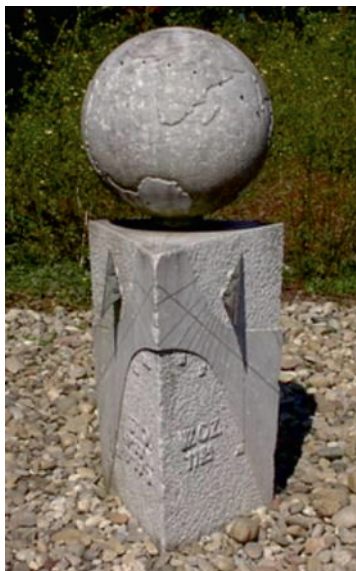
Vielfach-Sonnenuhr, Marmor, 1968. DGC 4602. Zwei vertikale Zifferblätter nach SO bzw. SW abweichend und Kugel-Sonnenuhr. Konstrukteur: Heinz Schumacher. Luisenpark, 68169 Mannheim-Oststadt, Baden-Württemberg.
