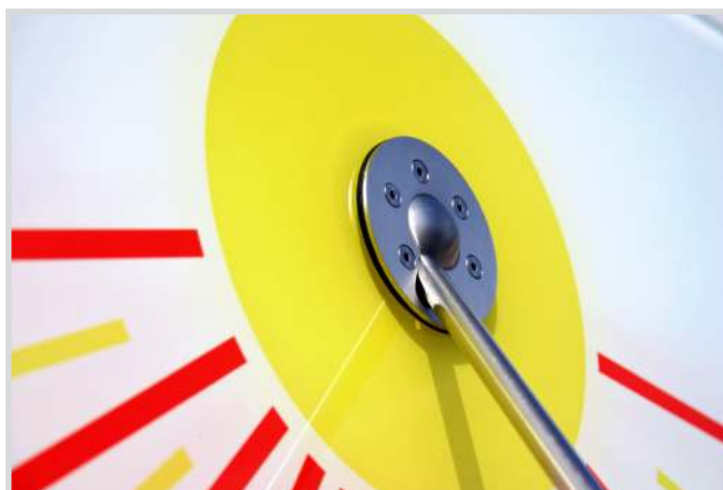
Die genaue Justierung des Schattenstab parallel zur Erdachse ist Voraussetzung, dass die Sonnenuhr präzise Zeit anzeigt.
